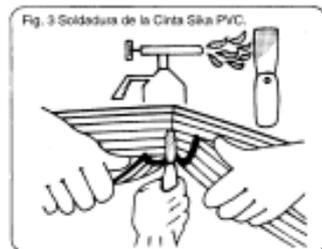
Cuando sea necesario unir la **Cinta Sika PVC AR-18**, corte los extremos de las dos Cintas a unir para crear una sección de pega lo más uniforme posible, coloque a tope los extremos de las Cintas (ver figura 3) y deslice entre ellos una espátula, llana o cuchillo caliente para que se funda el PVC. Presione inmediatamente los extremos calentados, quedando así realizada la soldadura.
