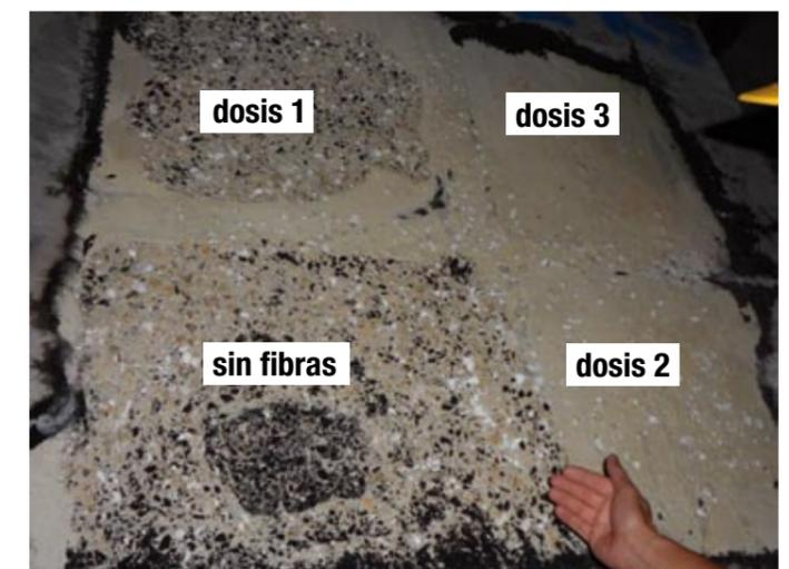
Prueba de resistencia al fuego de paneles de concreto reforzado con fibras<sup>[6]</sup>
