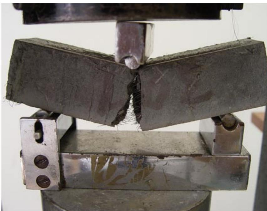
Prueba a la flexión de concreto con fibras para un Módulo de Ruptura de 200 kg/cm<sup>2</sup>.
