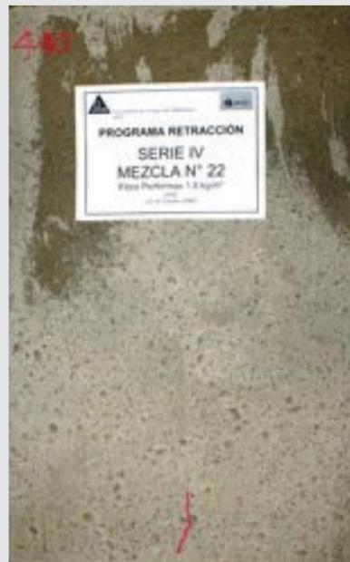
Las figuras 2-3 muestran la eficiencia de **Sikafiber AD**, luego de 24 horas de exposición a una velocidad de viento de 2 m/s. Se trata del mismo concreto solo que a una fracción de éste se le agregó 1 kg/m<sup>3</sup> de **Sikafiber AD**. (Laboratorio Sika-Colombia / 2009, Estudio de retracción plástica)
