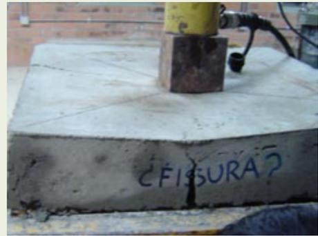
Ensayo EFNARC para determinar la absorción de energía en concreto lanzado. EN (14488-5) ver normas actuales que rigen el empleo de las fibras pág.26
