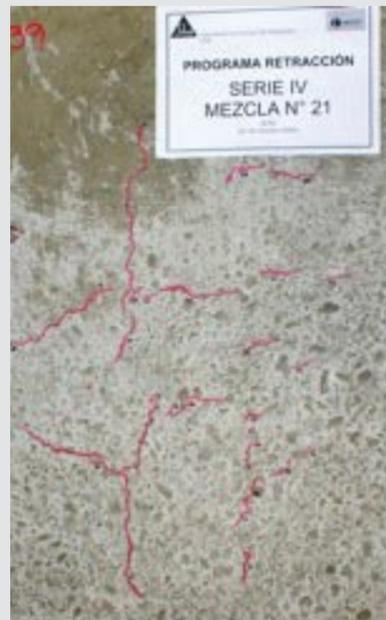
**Fig. 3 - Concreto 4000 psi a las 24 hrs con Sikafiber AD, expuesto a viento de 2 m/s**
