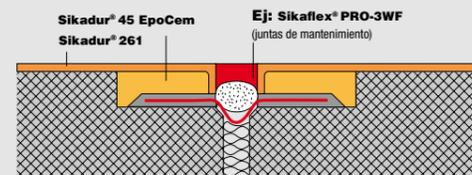
▲ Junta de expansión impermeable
