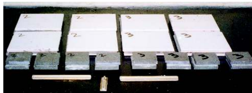
Muestras para ensayo de cortante de adhesivo látex para enchape según estándar ANSI A-118.4
