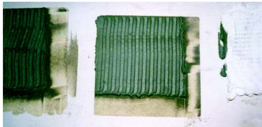
Ensayo de tiempo abierto de adhesivo látex para enchape según estándar ANSI A-118.4
