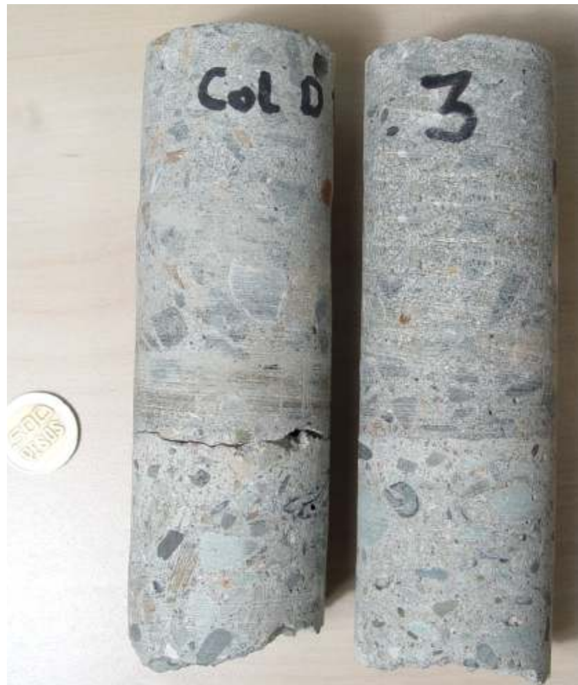
Núcleos extraídos de una columna recrcida con concreto para verificación de adherencia entre concreto nuevo y viejo.
