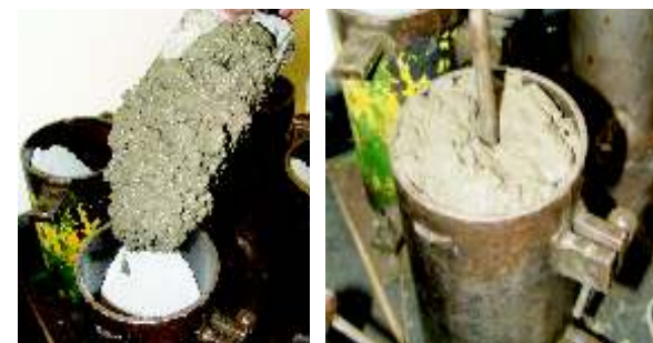
Proceso de elaboración de probeta para ensayo de adherencia de plano inclinado, pega de concreto fresco a endurecido con adhesivo epóxico.
