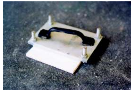
Ensayo de tiempo abierto de adhesivo látex para enchape según estándar ANSI A-118.4
