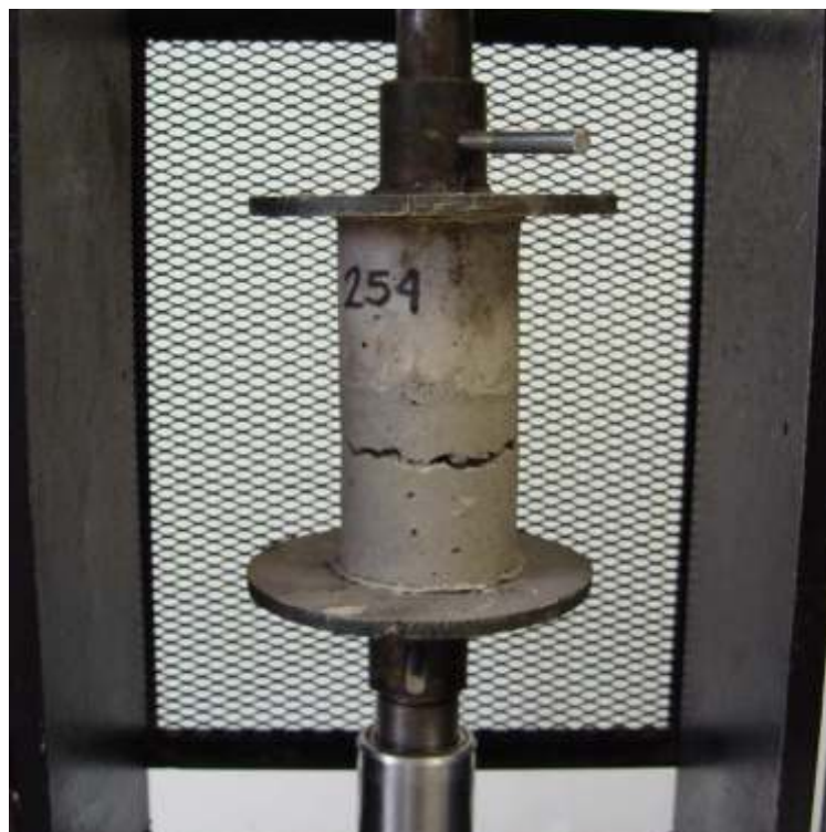
Ensayo de adherencia a tensión directa, pega de concreto fresco a endurecido con adhesivo epóxico.
