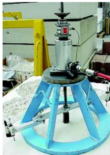
Equipo para ensayo no confinado a tensión de anclajes químicos [15].
