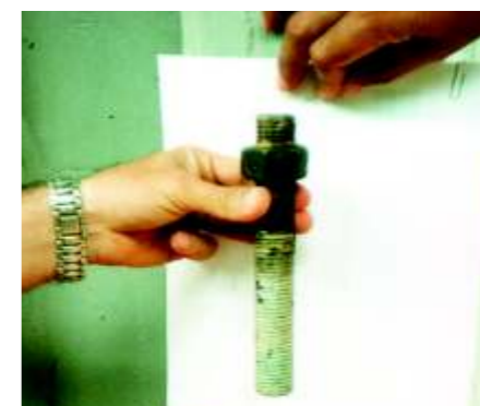
Falla de anclaje químico por temperatura ambiente de servicio mayor a la resistida por el adhesivo
