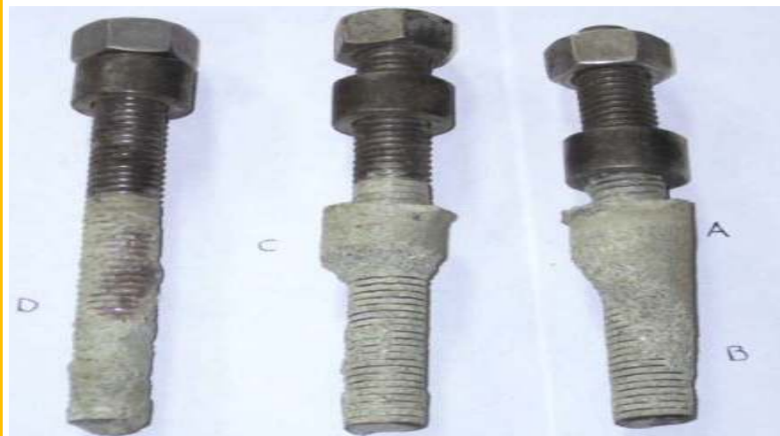
Falla de anclaje químico por mal mezclado de los componentes
