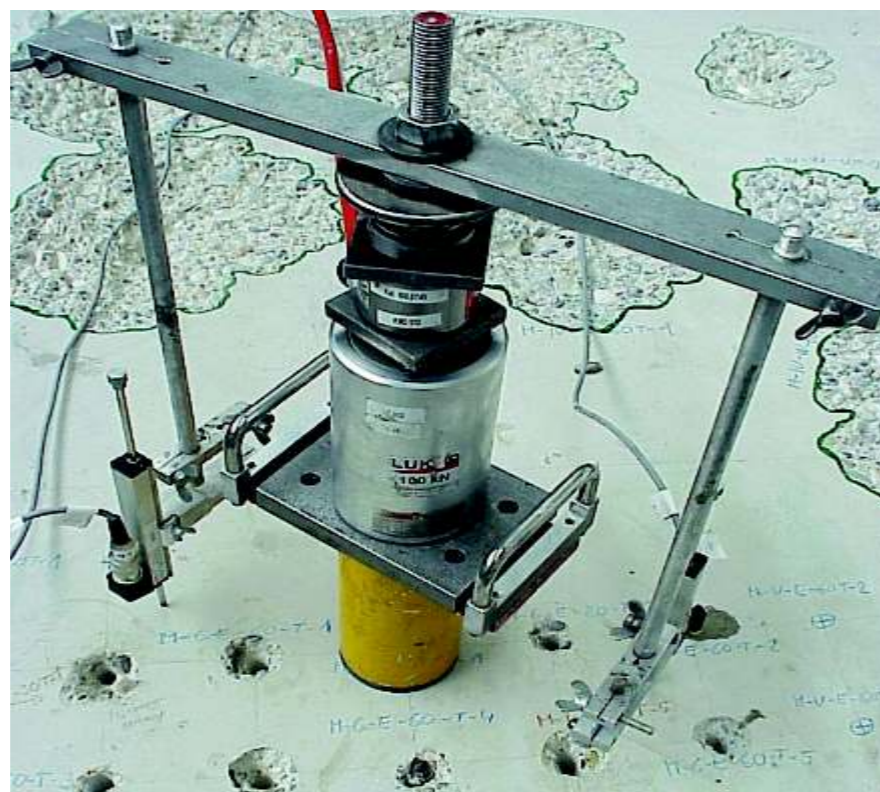
Equipo para ensayo confinado a tensión de anclajes químicos [15].
