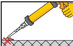
Presionar el gatillo de la pistola (aprox. 2 veces) hasta que se obtenga una consistencia y color uniforme del adhesivo; no usar este material sin mezclar.
