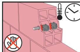
Durante el endurecimiento de la resina el anclaje no debe moverse o ser sometido a carga. Esperar el tiempo indicado según la temperatura. Las herramientas deben ser limpiadas inmediatamente con Sika Limpiador o solvente convencional. La piel debe ser lavada con agua tibia y jabón.
