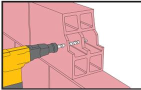
Perforación de agujeros con un taladro eléctrico al diámetro y profundidad requeridos. El diámetro del orificio de perforación debe estar de acuerdo con el tamaño del taquete perforado. Nota: con material hueco no utilice taladros de martillo rotativo.
