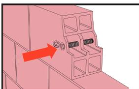
Inserte el taquete perforado por completo en el hueco del block.
