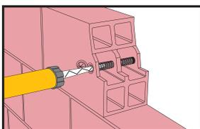
Inyecte el adhesivo en el taquete perforado, comenzando desde la parte inferior, mientras retira lentamente el mezclador estático. En cualquier caso, evite atrapar aire.
