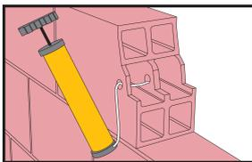
El orificio de perforación debe limpiarse después de cada paso de limpieza con una bomba de soplado o con aire comprimido, comenzando desde la parte inferior del orificio (bomba al menos 2x).
