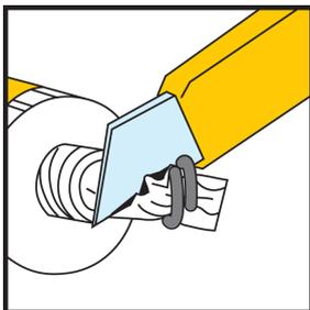
2. Cortar el polietileno de protección junto con el anillo metálico.
