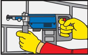
Realizar la perforación con taladro según el diámetro y profundidad requeridos para la fijación.
