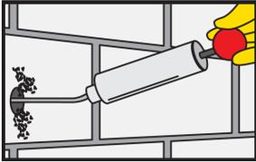
La perforación debe limpiarse mediante soplado (con bomba o sistema de aire comprimido), comenzando desde el fondo del orificio (al menos 2 veces).
