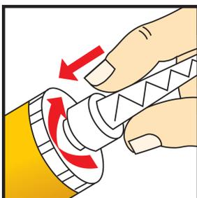
3. Enroscar la boquilla mezcladora en la rosca del cartucho.
