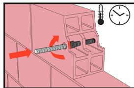
Insertar el anclaje con un ligero movimiento de giro en la perforación relleno de adhesivo. Debe salir algo de adhesivo por exceso. Importante: El anclaje debe ser colocado durante el tiempo abierto del adhesivo.
