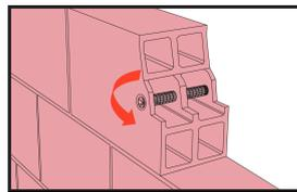
Cierre la tapa del taquete perforado para evitar que la resina se escape al entrar en la varilla de acero.
