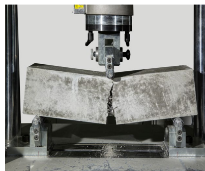
Ensayo de viga UNE EN 14651
