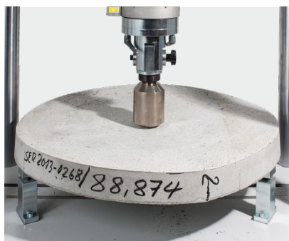
Ensayo de panel redondo ASTM C1550
