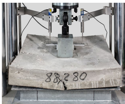
Ensayo de panel cuadrado UNE EN 14488-5
