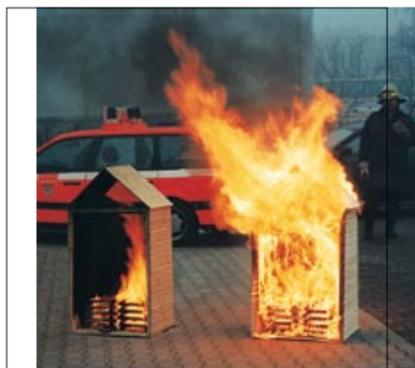
La belleza natural de la madera la convierte en un material de construcción con una multitud de usos. Sin embargo, es altamente inflamable y requiere de medios efectivos de protección, en especial cuando se usa en edificios públicos.
