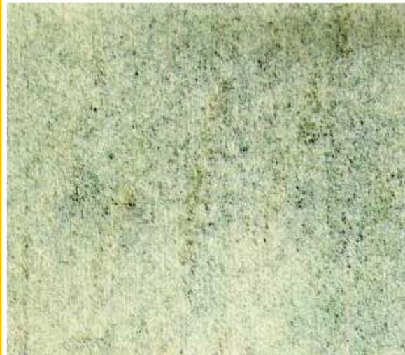
La limpieza con chorro abrasivo grado metal casi blanco, es un método de preparación de superficies metálicas para remover casi toda la cascarilla de laminación, la herrumbre, la pintura y las materias extrañas, por medio de un abrasivo impulsado a través de una tobera o por una centrífuga, hasta el grado aquí especificado.
