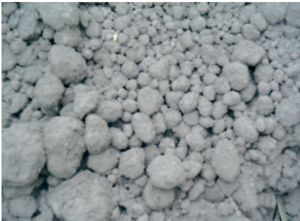
Foto No. 8: Microfotografía de una ceniza volante usada como adición al concreto.
