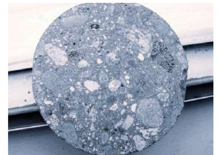
Foto No. 15: Rodaja de concreto convencional donde se puede apreciar la porosidad a simple vista.
