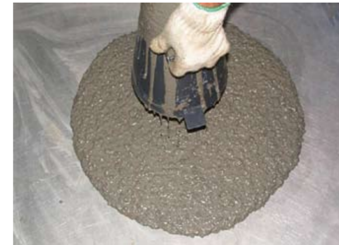
Foto No. 7: Medición del flujo de un concreto autocompactante. Nótese la homogeneidad de la mezcla.
