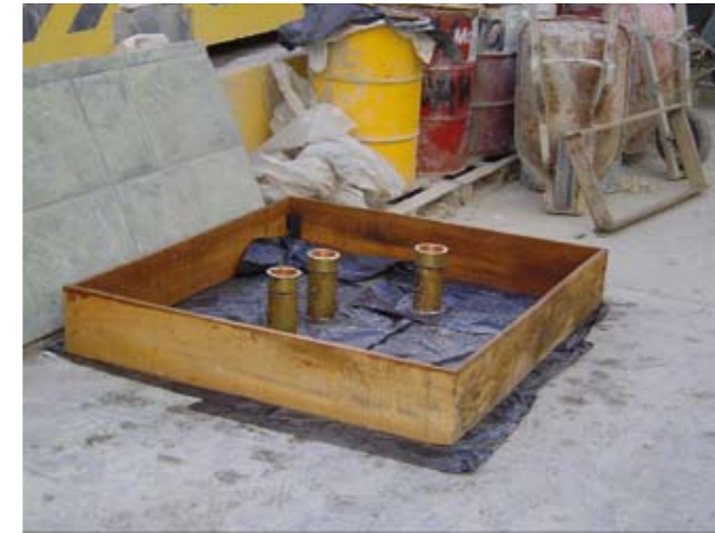
Foto No.3: Probetas de concreto de fácil extracción para el monitoreo de la ganancia de resistencia de una mezcla en particular.
