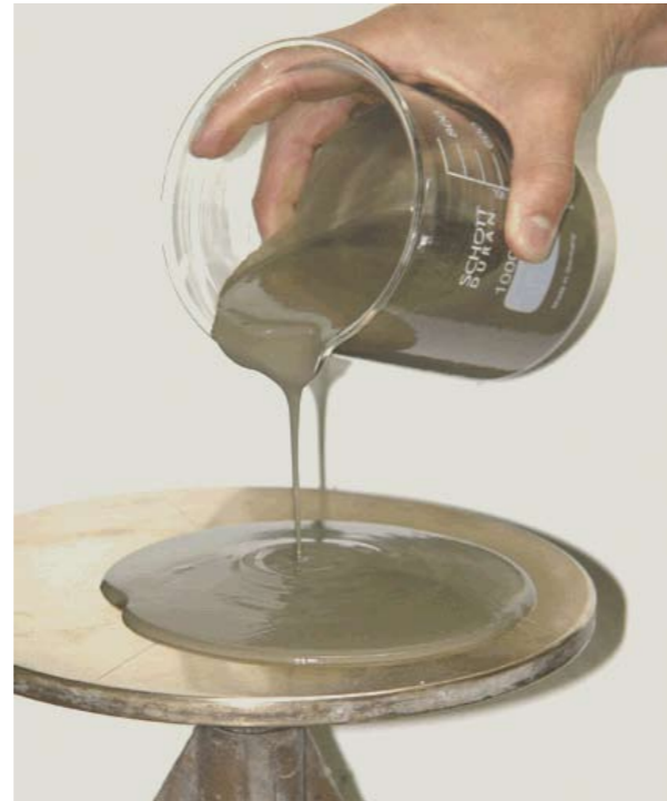
Foto No.1 Pasta de cemento con exceso de agua (lechada)
