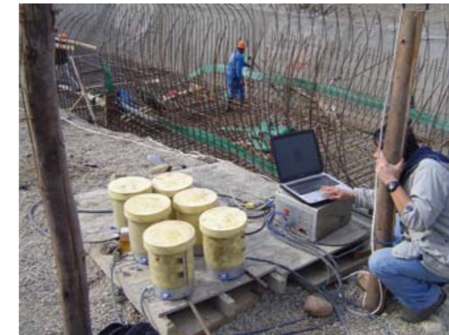
Foto No.4: Pruebas en obra con el equipo de "seguimiento térmico" para resolver problemas en la obtención de la resistencia inicial adecuada para descimbrar.
